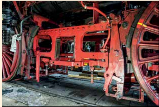
Der Rahmen ist geputzt und vorbereitet für den Einbau.
