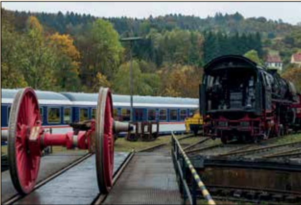
Die einbaufertige Achse „bereit zur Versenkung“ ...
