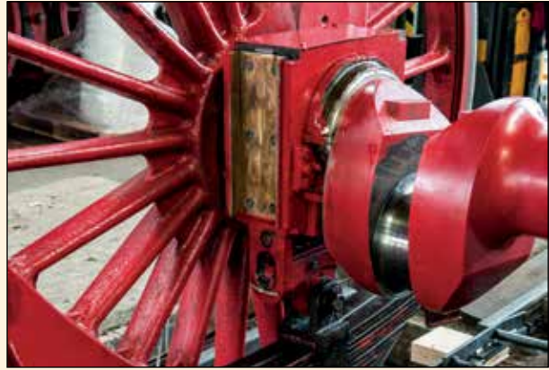
Das instandgesetzte Achslagergehäuse.
