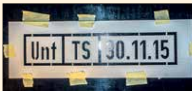
Unser Wagen D-HDS 56 80 22-40 717-1 hat im November 2015 eine neue Hauptuntersuchung erhalten. Auch die Wagenanschrift wurde in Tupftechnik ergänzt.
