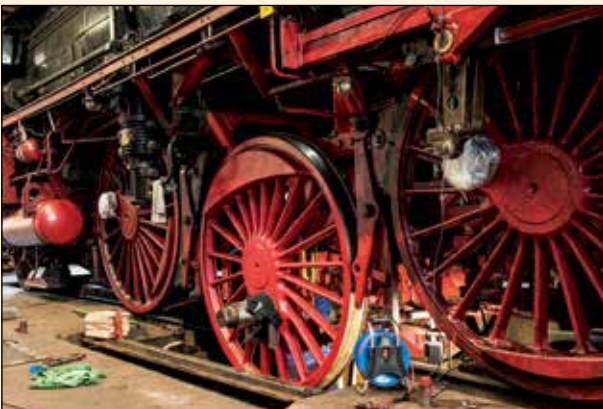
Fast hat die Achse wieder ihren Sitz erreicht. Jetzt „nur noch“ die Bremse und die Stangen montieren und den Tender ankuppeln.
